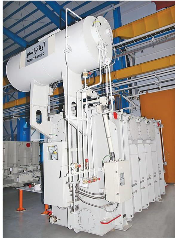
با توجه به اینکه پست محل نصب ترانسفورماتور در عمق ۱۳ متری زیر زمین قرار دارد به منظور افزایش ایمنی در هنگام بروز خطا در این ترانسفورماتور از پوشینگ‌های plug-in و مایع استر استفاده شده است. استفاده از پوشینگ‌های plug-in باعث افزایش ایمنی الکتریکی محیط و همچنین کاهش ابعاد نهایی ترانسفورماتور و در نتیجه کاهش فضای مورد نیاز برای نصب ترانسفورماتور می‌شود. این راه حل فنی بهترین گزینه برای پست‌های زیرزمینی فوق توزیع از نظر ایمنی حریق و فضای محدود مورد نیاز می‌باشد.
